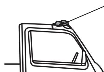
運転席ドアを開け、配線ケーブルを屋根から車両側のドアゴムに沿わせて車内に引込む。
