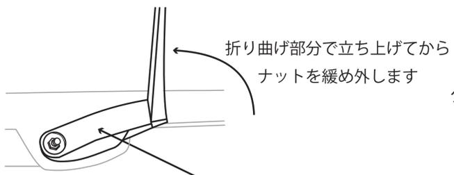
3. ナットを外したら「ワイパー固定部」を手前に引き出し外します。
