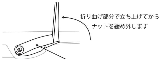
3. ナットを外したら「ワイパー固定部」を手前に引き出し外します。
