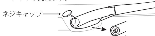
ワイパーを戻す場合は「現在の位置」に戻しますので、ワイパー先端・上位置のガラス面に、テープ等で目印をしておくと良いでしょう。
