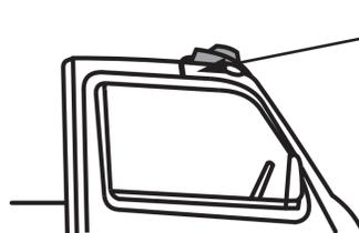
運転席ドアを開け、配線ケーブルを屋根から車両側のドアゴムに沿わせて車内に引込む。
